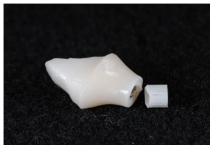
4-5 破折したジルコニアアバットメント。
