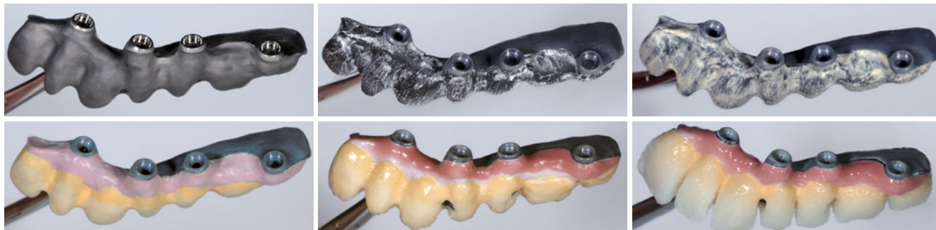
3-4 インプラントブリッジフレームの焼成回数を重ねるごとの接合部の酸化被膜の付着。
