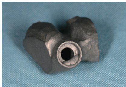
4-2 ワックスアップ法による鑄造欠陥。
