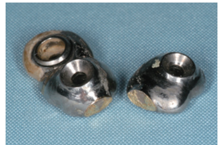
4-3 ロウ着部の経年劣化による破断。
