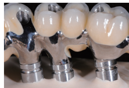
4-9 複数回焼成後、完成した上部構造のワンスクリューテスト。
