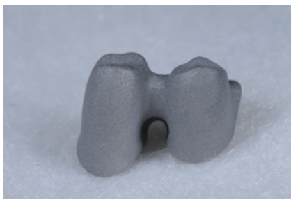
2-7 125 \mu mのアルミナサンドブラスト処理を施し、不動態化処理を行う。
