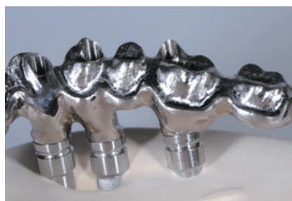
4-8 ミリングされたフレームの築盛前のワンスクリューテスト。
