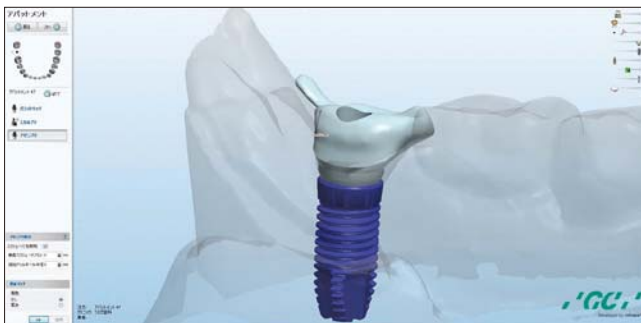
3-9 アバットメントにアクセスホールを付与した最終的な形態の確認。
